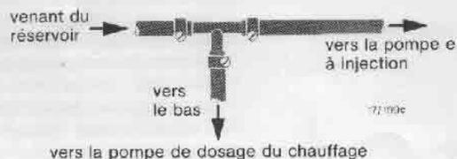
Si le prélèvement sur la conduite de carburant n'est pas possible, par ex. parce que la pompe électrique à carburant est logée dans le réservoir, l'alimentation en carburant doit être effectuée à l'aide d'un raccord distinct du réservoir. Voir sous (2) ou consulter le fabricant.
