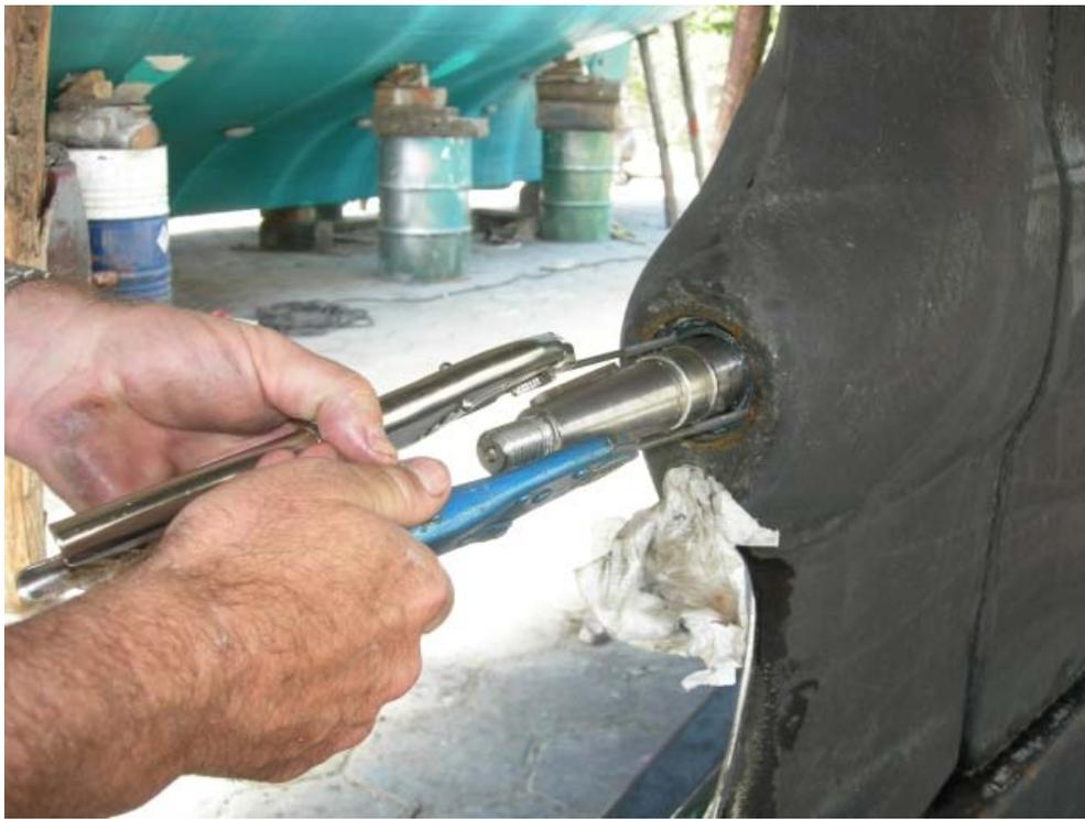
NB : cette opération ne marche pas toujours. Si le joint est trop collé, il faut couper la rondelle de métal dans le joint, puis l'extirper à l'aide d'un petit tournevis et d'une pince.
