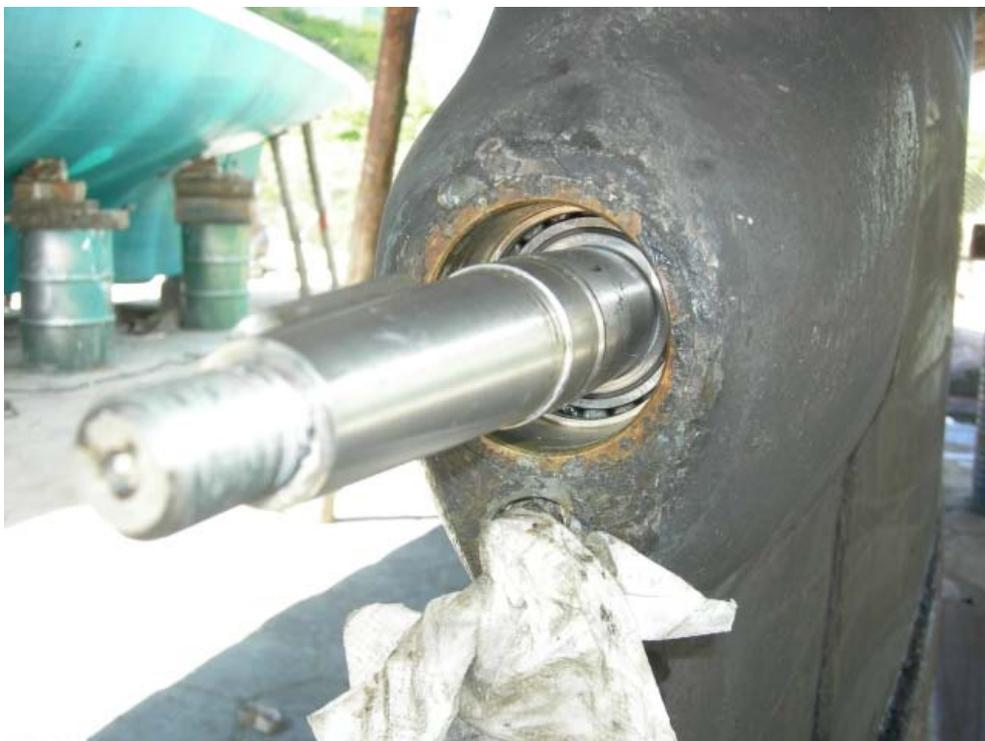
Ôter le Sopalin et refermer le trou de vidange en revissant le boulon préalablement graissé. Vérifier l'intégrité du joint de ce bouchon. Il n'est pas mal d'en avoir une paire de réserve pour un grand voyage.
