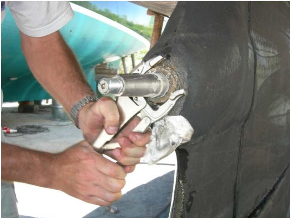
Avec une pince GRIP à large ouverture, imprimer des mouvements rotatifs pour extirper la bague d'usure.
