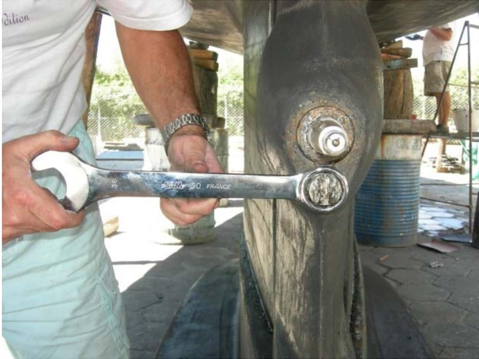
Dévisser le bouchon de vidange de la transmission avec une clé de 36 si vous êtes équipé d'un coupe-orin SPURR. ATTENTION, cette clé est difficilement trouvable et il faut l'avoir à bord en voyage.
