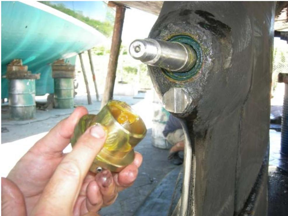
Les 3 joints sont posés. Il faut enduire la bague d'usure de graisse avant de l'enfiler. La bague d'usure rentre sans problème jusqu'à la butée de l'O-ring interne qui assure l'étanchéité entre la bague et l'arbre. En général, cela ne rentre pas à la main, même avec de la graisse. Il faut alors réutiliser le tube d'acier pour pousser la bague à fond.
