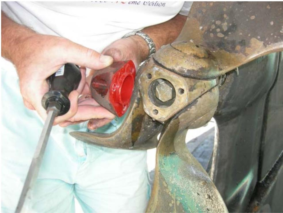
Une fois le nez ôté, l'écrou de fixation de l'hélice apparaît.
