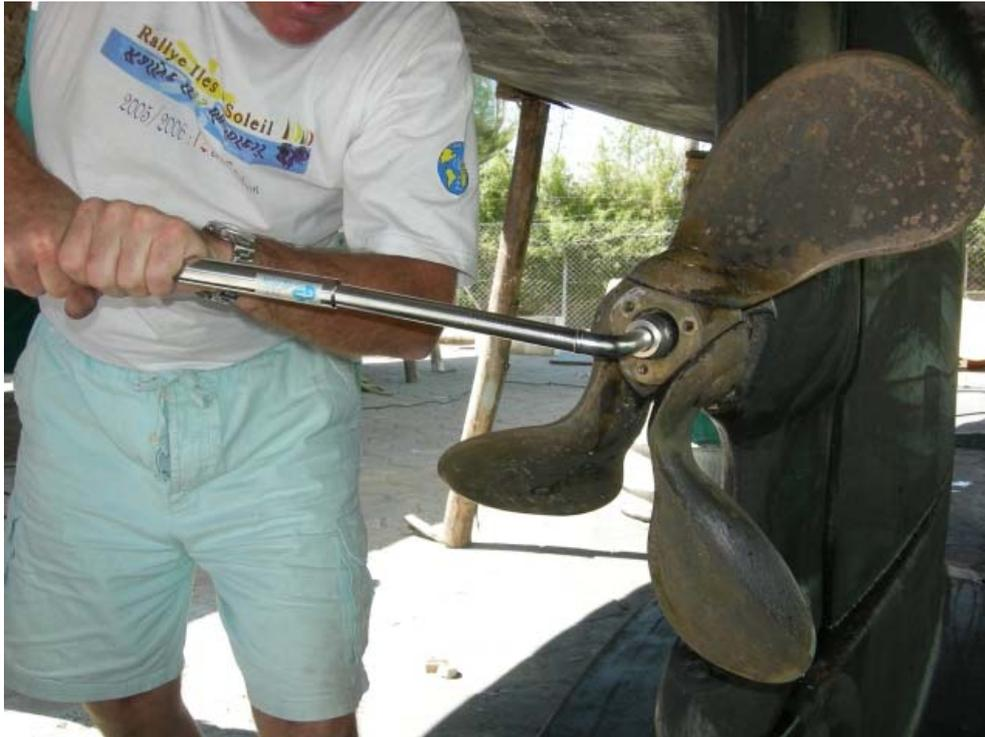
Dévisser l'écrou de fixation de l'hélice. Il est judicieux d'armer le bateau d'une clé télescopique pour roue de voiture. Cela permet de dévisser avec certitude et de visser avec sécurité. La dimension de la douille entre dans la série habituelle d'une boîte de bricolage.
