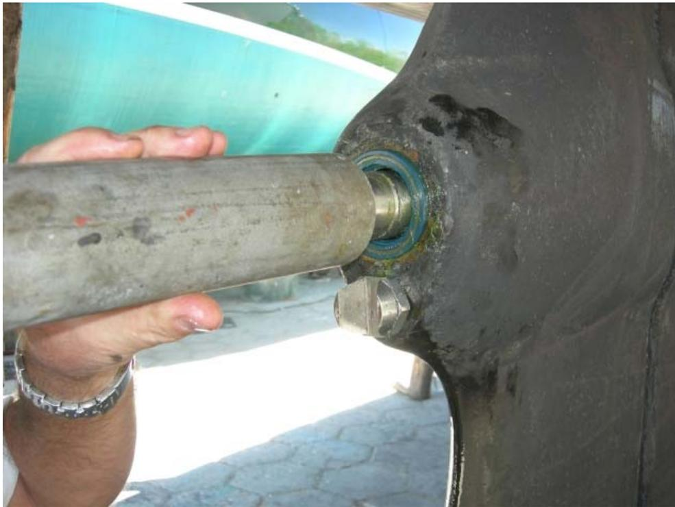
Poser le premier joint en l'enfonçant légèrement à la main. Puis enfoncer le totalement en vous servant d'un tube d'acier au diamètre 60 mm dont vous vous serez équipé auparavant.
