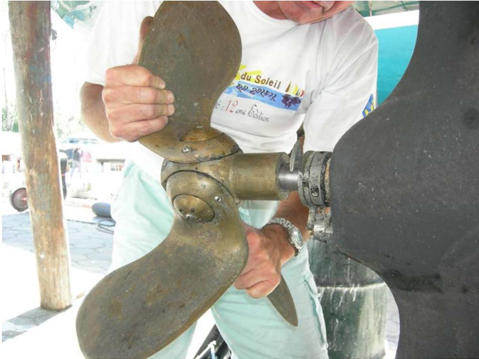
Tirer l'hélice vers l'arrière. Cela ne vient jamais seul, même en cas de montage avec un peu de graisse sur l'arbre. Il faut parfois « sonner » l'hélice avec un maillet de carrossier ou à défaut avec un marteau. On frappe avec le marteau sur un bout de bois posé sur le moyeu de l'hélice.
