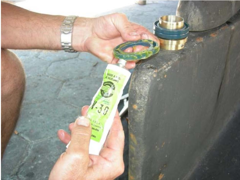
Prendre une nouvelle bague d'usure et bien repérer la position des joints. Amel les fournit avec les joints posés dans le bon sens, c'est-à-dire 2 joints avec les ressorts orientés vers l'avant du bateau et un joint avec le ressort orienté vers l'arrière du bateau. C'est la face avec le ressort qui assure l'étanchéité. Donc 2 étanchéités pour l'huile et 1 étanchéité pour l'eau de mer.
