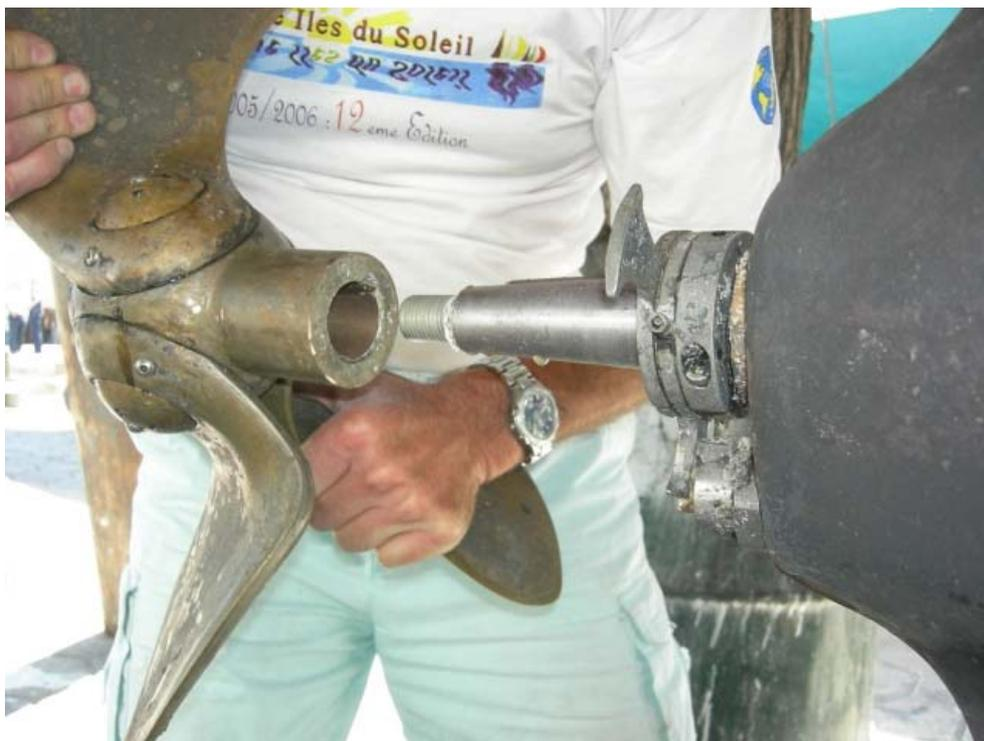
Une fois l'hélice ôtée, on laisse la clavette dans le cône de l'arbre.
