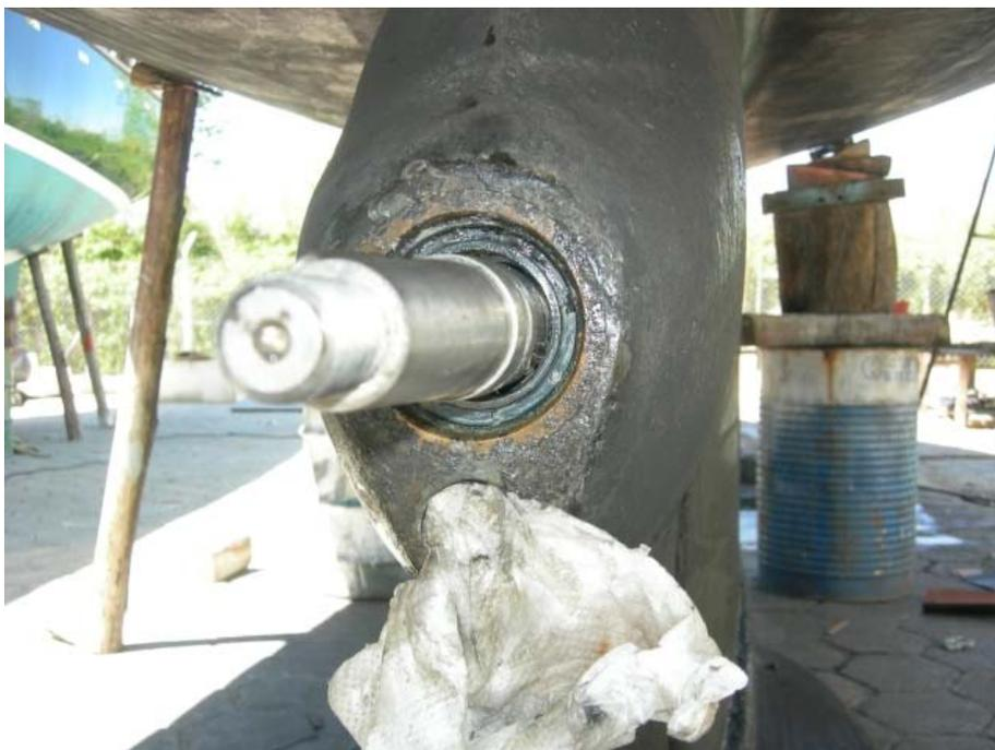
Une fois ôtée, les joints à ressort apparaissent.
