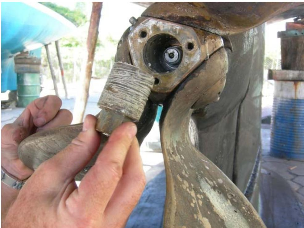
On voit ici l'écrou sorti et le résidu de graisse du précédent montage.
