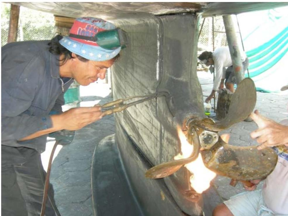
Parfois, cela ne suffit pas et il faut chauffer le moyeu de l'hélice. Nous avons pour ce faire un pistolet « Soudogaz » de Camping Gaz, mais durant ce reportage, un soudeur était occupé sur le bateau voisin. Pratique ... Amel fournit également un arrache-hélice qui se fixe à la place du nez de l'hélice, mais en général, cela ne suffit pas.
