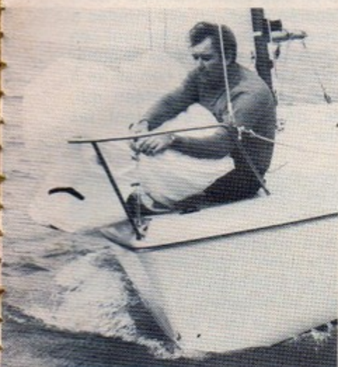
L'accastillage de l'étrave simple mais efficace manque toutefois d'un dispositif pour la chaîne d'ancre.
