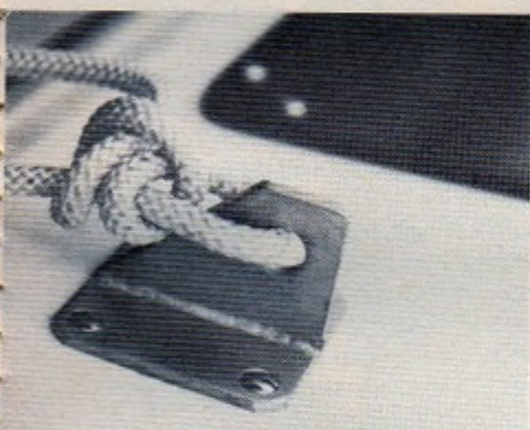
Un ouvre-bordés très efficace, avec de telles ferrures de béquilles, l'amarrage à couple n'est pas conseillé.
