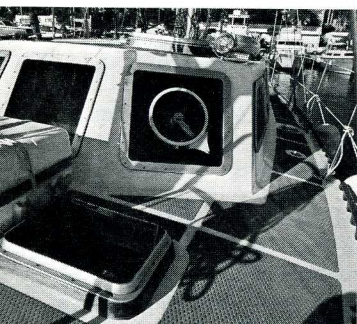
Fig. 202 – Une timonerie basse et renforcée.
