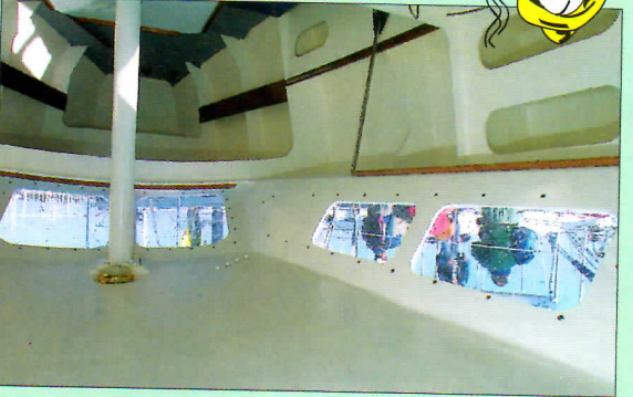
Bonne idée : le rouf du Filo est équipé sur l'avant de hublots permettant de surveiller le plan de voilure.
