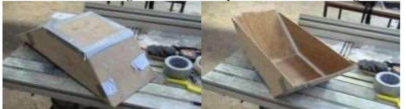
Découper dans la cloison longitudinale la position de la boîte des pieds en faisant attention au pont en V : la boîte doit dépasser de quelques cm pour que les côtés soient à la bonne hauteur.
