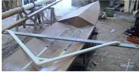
Stratifier le carbone en 4 épaisseurs de 300 gr/m<sup>2</sup>. Découper les bandes et faites-les se croiser sur le point A. Ajouter 2 plis de 20 cm à l'endroit des boulons de fixation sur le livet.
