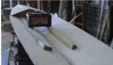
Faire des essais sans colle pour s'assurer que le pont repose bien partout où c'est prévu. On peut utiliser le poids d'une batterie posée sur deux bouts de bois droits pour assurer la pression et la droiture du pont là où viendront les coulisses, plus un ou deux serre-joints au tableau arrière.
