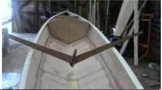
Serre-bauquière au niveau de la cloison centrale, à gauche vers l'avant ; et vers l'arrière, taillée au bon angle.
