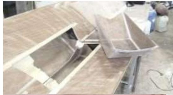
Ajuster avec prudence. Le pont en V induit un angle dans la découpe des bords.
