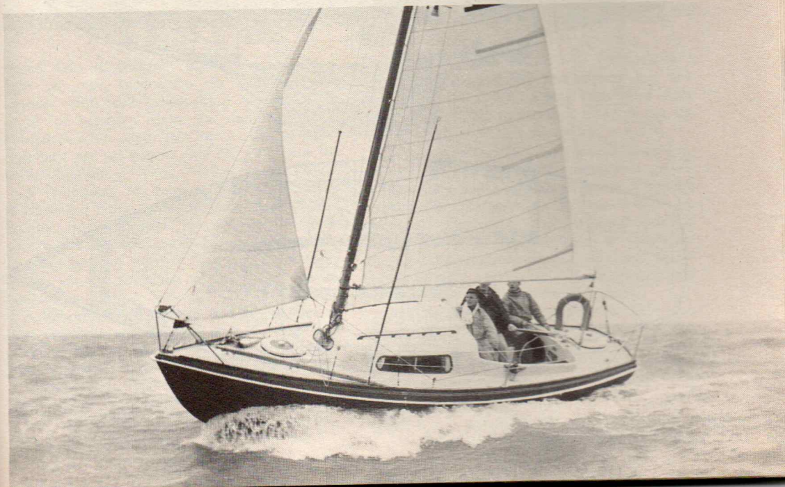
Le plastique a permis de donner aux superstructures des formes très douces.
